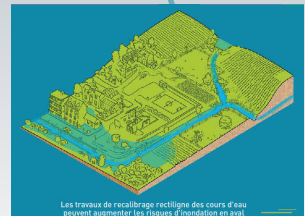
Les travaux de recalibrage rectifié des cours d'eau peuvent augmenter les risques d'inondation en aval
